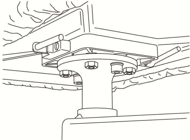
3. Lors de la réinstallation du plateau inférieur assurez-vous que les trous de montage (3) de la plaque de travail sont placés correctement face aux goupilles de verrouillage du support.
