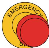
Appuyer sur le bouton d'arrêt d'urgence ne fait que lever la plaque chauffante. La ligne électrique ou la ligne pneumatique n'est pas interrompue. **DANGER D'ACCIDENT**
